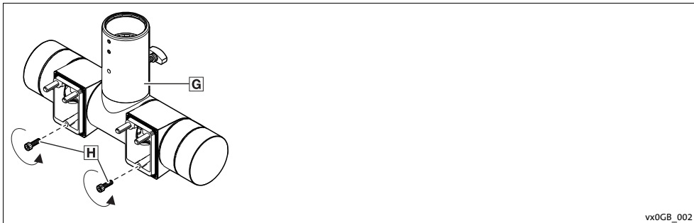
Abb. 2 Tragam-Adapter für die Montage vorbereiten
