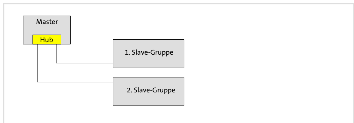
Abb. 5-2 Stern-Topologie für 1 bis 2 Slave-Gruppen
