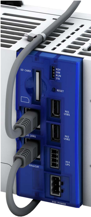
Abb. 1: Verlegung und Fixierung der Netzkabel
