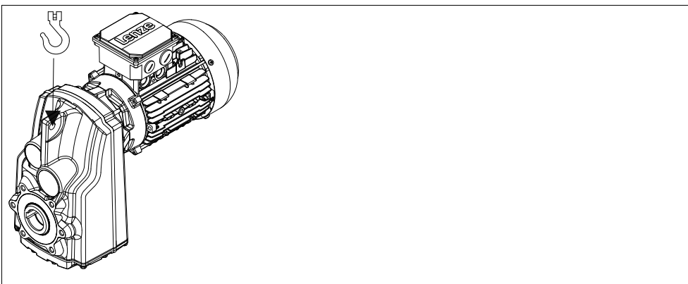
Abb. 2 Tragöse für den Transport des Gesamtantriebs
