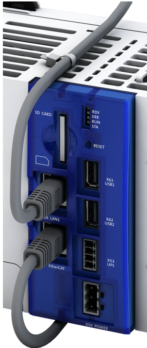
Abb. 1: Verlegung und Fixierung der Netzkabel
