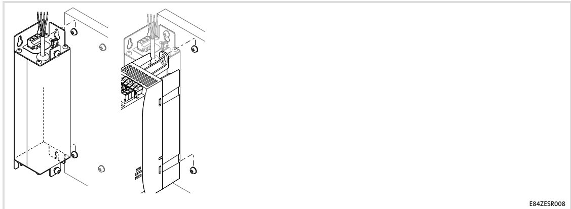
Abb. 5-6 Montage mit Nebenbaufilter
